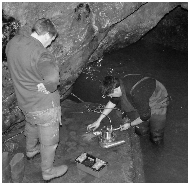
Relevé et entretien du fluorimètre à la station de contrôle placée dans la grotte de Remouchamps (dans la rivière du Rubicon). Ce site fait l'objet d'un suivi des fluctuations de débit et de qualité chimique des eaux. La mise en évidence de corrélations entre les paramètres chimiques et physiques est particulièrement riche en enseignements quant au mode de fonctionnement de l'aquifère.
