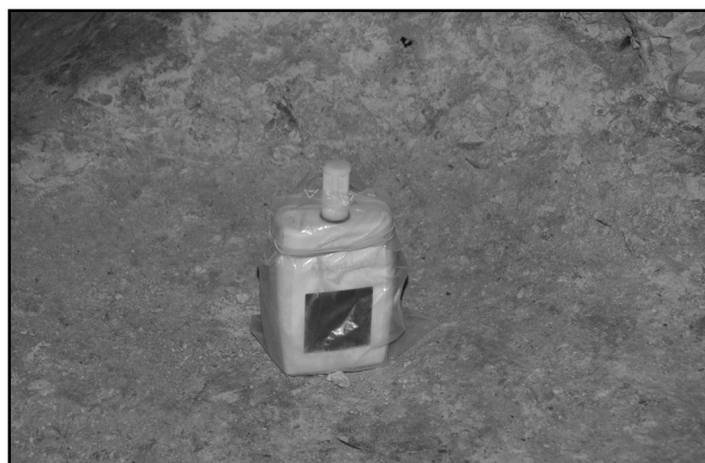
Data-logger placé dans la mine de Petit-Spiennes, mesurant les fluctuations de la température et de l'humidité relative en continu.
