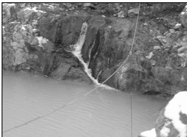
Dans la carrière Berthe (Florennes), une des venues d'eau a formé un véritable "lac" dans le fond de l'exploitation, nécessitant un pompage constant pour approfondir la carrière (Photo F. Van Dijk)
