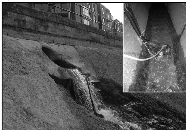
Figure 2 : Fontaine Patenier (octobre 2007) équipée du fluorimètre FL30.
