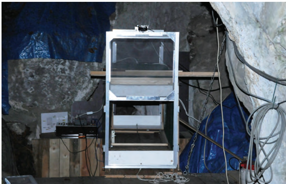
Faïence d'entrée du trou Picot a été réduite volontairement à cette unique lucarne de passage pour obliger les « hôtes » de la grotte, à emprunter cet étroit passage équipé de fermetures automatiques
