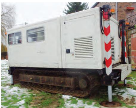
Camion-chenille utilisé pour les tests de pénétration (10 tonnes à la pointe)
