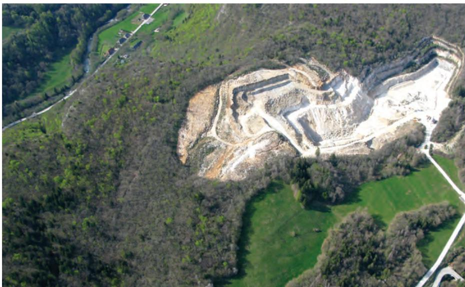
La Carrière de Bellecombe entaille profondément le massif rocheux, au risque de recouper ses réseaux karstiques (photo prise en parapente).
