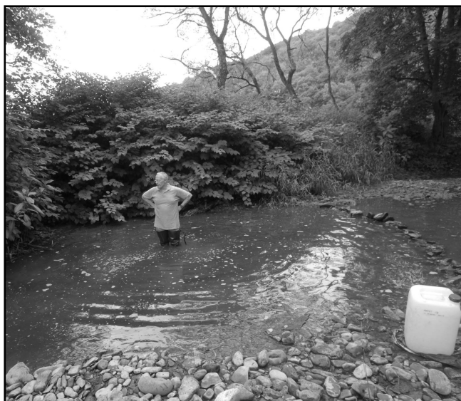
Tentative échouée de traçage avec de l'acide aminoG dans la perte partielle face à Waerimont (pt E).
