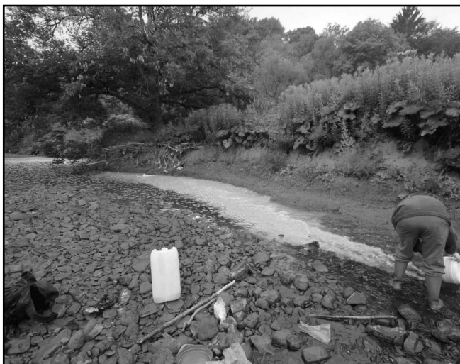
Injection de 527g d'uranine dans la perte provisoire de la Lomme (au lieu-dit « Prairie Lhoist »)
