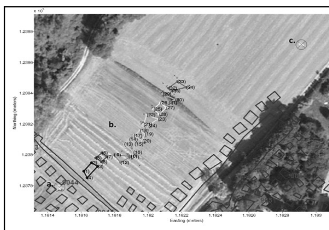
Figure 4 - Site n°2 - Levés topographiques à l'aide de l'UGPS3.
