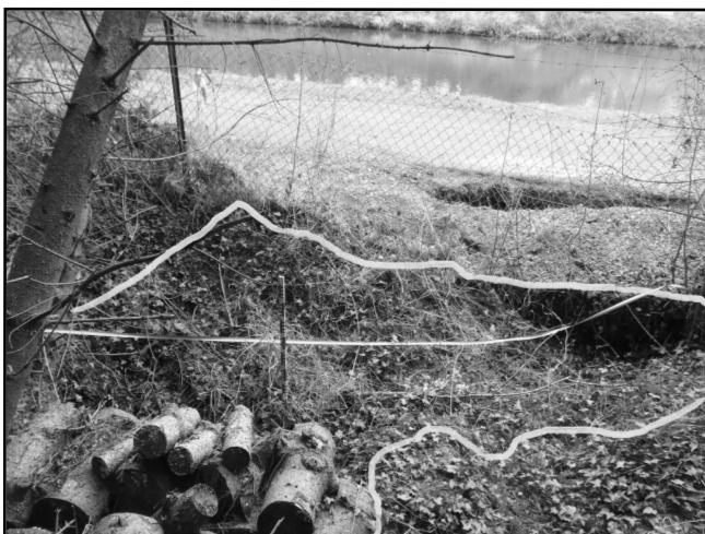
Fontis S4, en bordure du chemin de Hallage. un approfondissement de cette dépression pourrait produire une nouvelle perte dans le canal et affecter le captage voisin (Photo JP Liégeois - mars 2013).
