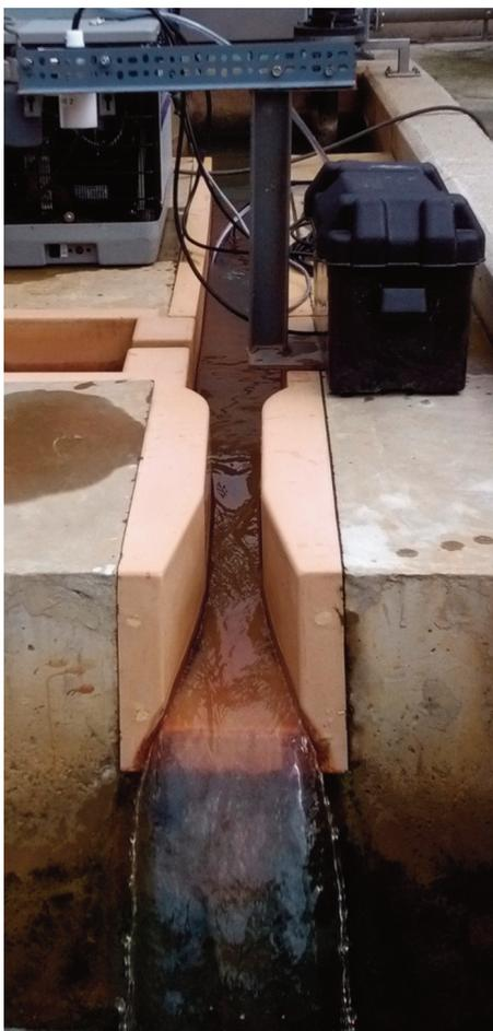
Fig. 5. Canal Venturi de l'entreprise Benechim. Avec à gauche un capteur ultrasonique en aplomb du puit de mesure © ISSEP
