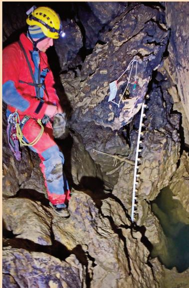
Bilborupt installé au pied du Puits Tourne-sol, réseau du Noû Bleû © V.Gerber
