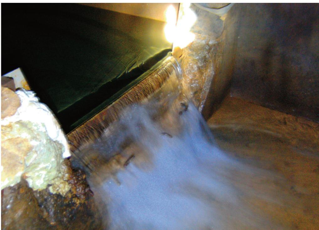
Fig. 9. Déversoir trapézoïdal (Cipolletti) de la Grotte du Châlet (Aywaille)
